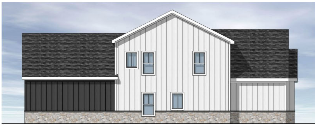
③ RIGHT ELEVATION Scale: 1/8" = 1'-0"
